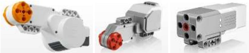
сервомотор EV3 средний сервомотор EV3 сервомотор NXT
